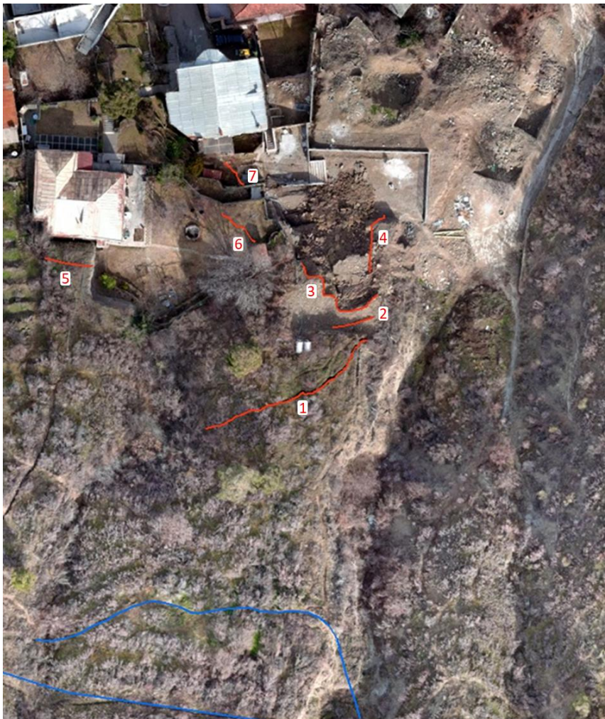
სურათი 3: დაკვირვებადი ნაპრალები (წითელი #1-7) და წყალსადენი მილები (ლურჯი). მასშტაბი 1:500
